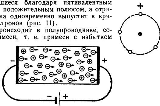
Рис. 11. Проводимость в полупроводнике типа n . Свободные электроны (помечены знаком минус) отрываются от пятивалентных атомов, которые из-за этого становятся положительными ионами (помечены знаком плюс).
